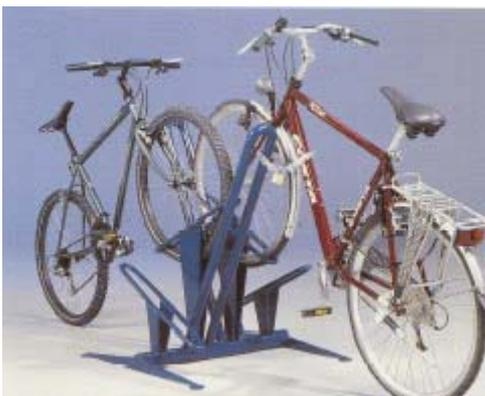
Râtelier permettant d'attacher le vélo par le cadre à un poteau en tube cintré formant un U. Le guide roue dans lequel est placée la roue avant épouse parfaitement sa forme, gage de stabilité. Ce système permet le maintien de pratiquement tout type de vélo quelle que soit la largeur du pneu. Compact : La distance entraxes des vélos est de 375 mm, Avec guides roues alternés haut et bas. Existe en modèle simple et double (tête bêche) de 2 à 8 places. Râtelier à boulonner.
