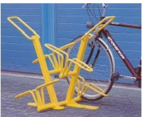
Râtelier permettant d'attacher le cadre du vélo à un poteau. Les guides roues épousent parfaitement la forme de la roue, gage de stabilité. Ce système permet le maintien de pratiquement tout type de vélo quelle que soit la largeur du pneu. La distance entraxes des vélos est de 375 mm, disposition alternée haut et bas. Le poteau pour la fixation de l'antivol est haut de 90 cm. Râtelier à boulonner. Existe en modèle simple et double (tête bêche) de 2 à 8 places. Râtelier à boulonner.
